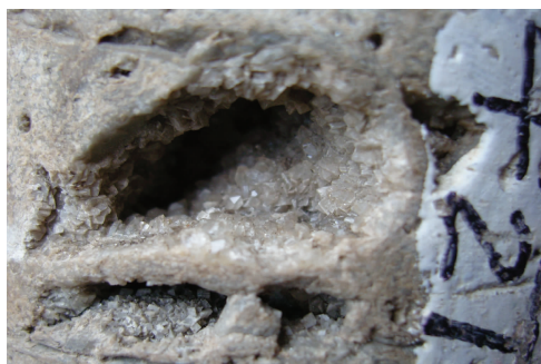
图7 塔深1井岩心(四回次)内生石英呈皮壳状分布于溶蚀孔洞表层
